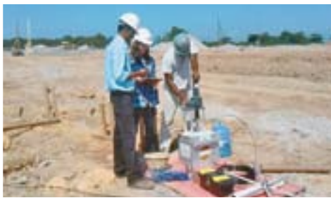
A confirmação da melhoria do solo com ensaios pressiométricos.
