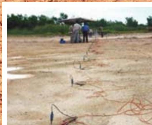
Paralelamente, fazemos ensaios geofísicos e piezométricos para verificação da rigidez do solo tratado.
